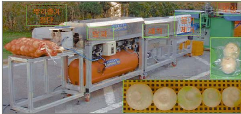
<양파 탈피 · 세척 · 포장 일관기계화 시스템>
