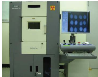
X-ray를 이용한 종자 건전도 분석
